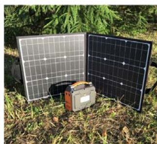
Рис. 2. Солнечная мини электростанция и аккумулятор
